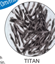
Material:TITAN V=75m/min. f=0.18mm/tooth S=1500min -1 F=1700mm/min.
