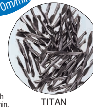
NC5-63 Material: S53C V=500m/min. f=0.25mm/tooth S=10000r/min F=10000mm/min.
