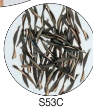
NC5-63 Material: S53C V=500m/min. f=0.25mm/tooth S=10000r/min F=10000mm/min.
